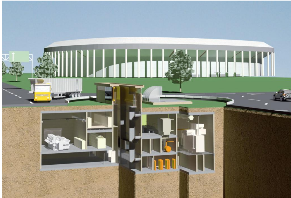
شکل (۱-۸): نمایی از پست زیرزمینی
