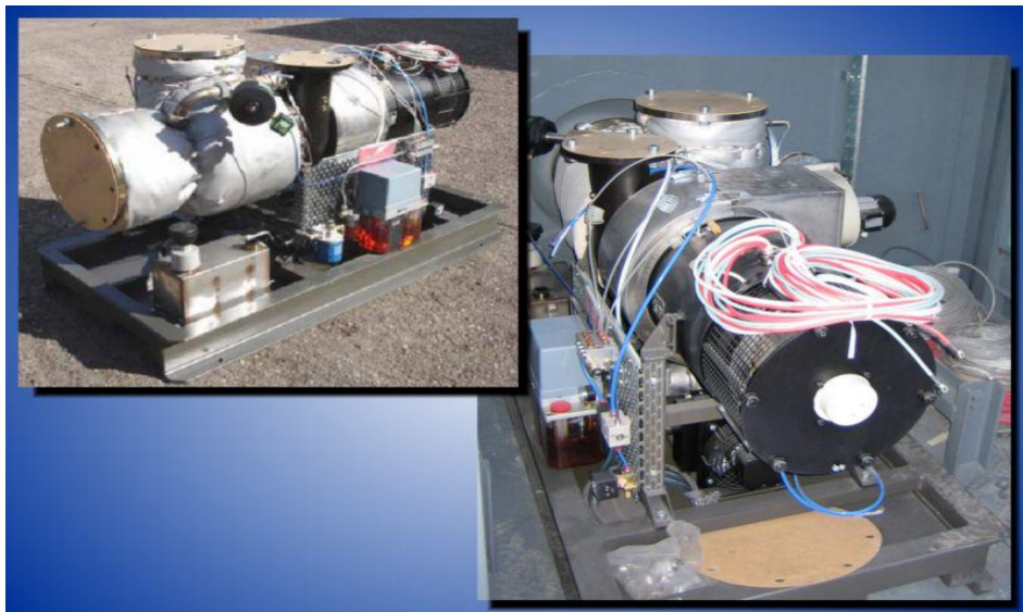
شکل (۱-۲۷): نمای یک میکروتوربین بدون محفظه محافظ
